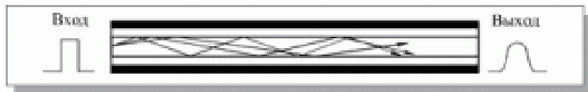
Рис.9 – Распространение света в многомодовом кабеле
