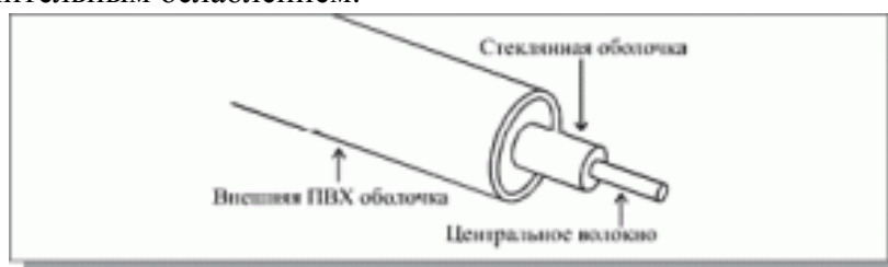
Рис.7 – Структура оптоволоконного кабеля
