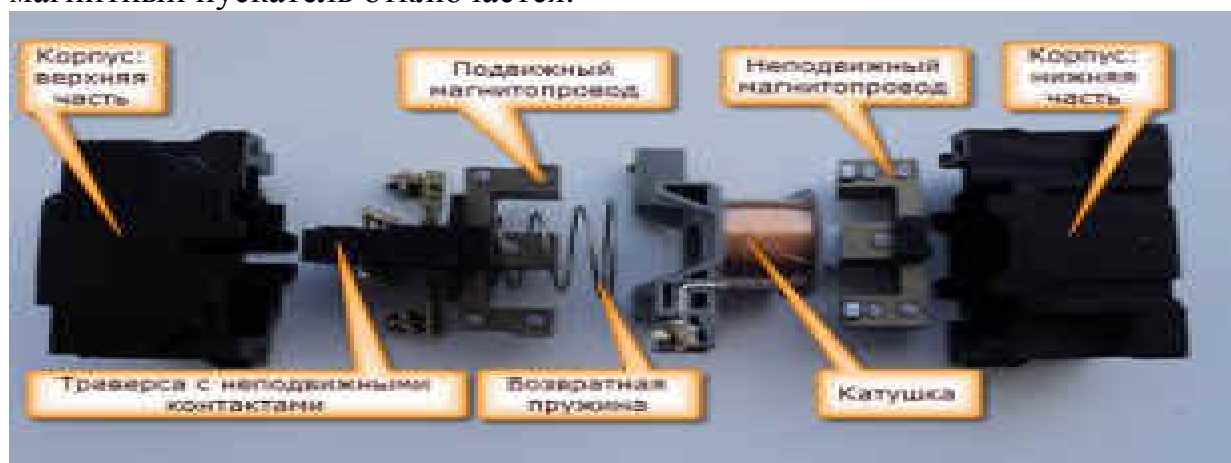
Рисунок 1 Устройство магнитного пускателя ПМЛ
