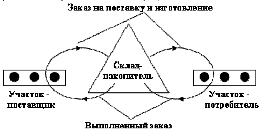
Рис. Схема объединенного контура регулирования
