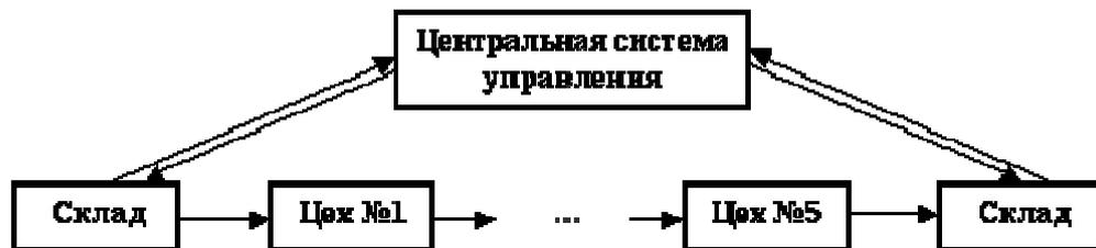
Рис. 2.2.4. Выталкивающая система управления материальными потоками
