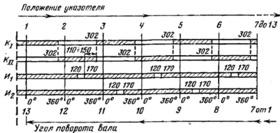
Рис. 2. Круговая диаграмма переключающего устройства типа РНТА-35/1000. Заштрихованная часть — контакт замкнут; незаштрихованная часть — контакт разомкнут.
