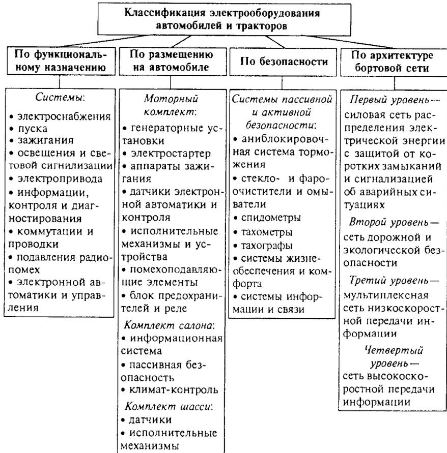
Рис. 1.2. Общая классификация систем электрооборудования автомобилей и тракторов
