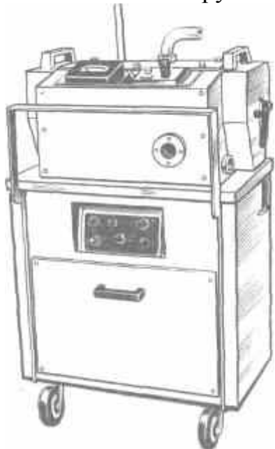
Рис. 3. Прибор К-408 для определения уровня дыма в отработавших газах дизельного автомобиля.
